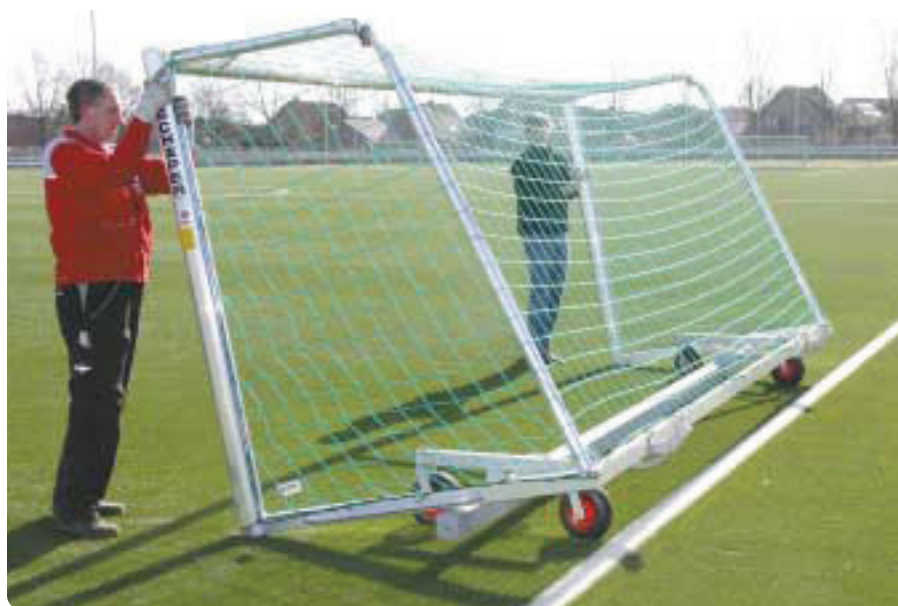
Die versetzbaren Tore müssen unbedingt verankert werden.
